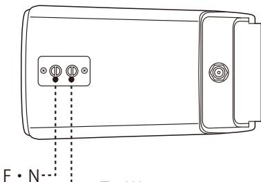
本体底面に、調整ネジがついておりますので、調整を行って下さい。
